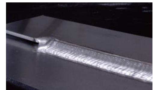
● 溶接電流: 120A ● 溶接電圧: 16V ● 板厚: 3.0mm ● ワイヤ径: φ1.2mm ● 溶接速度: 50cm/min ● ウェーブ周波数: 2.5Hz
