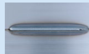
● 溶接電流: 300A ● 溶接電圧: 22V ● 板厚: 3.2mm ● ワイヤ径: φ1.2mm ● 溶接速度: 150cm/min ● ワイヤ送給速度: 11.0m/min ● 突き出し: 15mm
