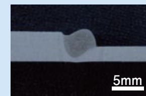
● 溶接電流: 300A ● 溶接電圧: 22V ● 板厚: 3.2mm ● ワイヤ径: φ1.2mm ● 溶接速度: 150cm/min ● ワイヤ送給速度: 11.0m/min ● 突き出し: 15mm
