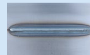
● 溶接電流: 300A ● 溶接電圧: 22V ● 板厚: 3.2mm ● ワイヤ径: φ1.2mm ● 溶接速度: 150cm/min ● ワイヤ送給速度: 11.0m/min ● 突き出し: 15mm
