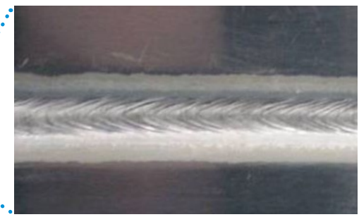
● 溶接電流: 280A ● 溶接電圧: 21V ● 板厚: 1.5mm ● ワイヤ径: φ1.2mm ● 溶接速度: 160cm/min
