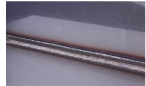
● 溶接電流: 145A ● 溶接電圧: 23V ● 板厚: 2.0mm ● ワイヤ径: φ1.2mm ● 溶接速度: 100cm/min
